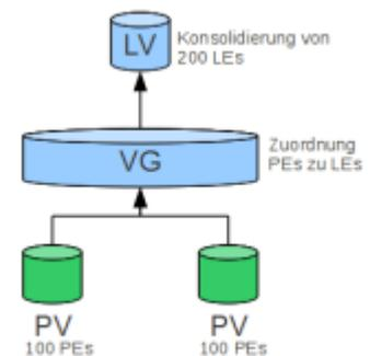
1. Linear Volumes: Eine geordnete Zusammenfassung von PEs zu einem LV. Die Größe der darunter liegenden PVs muss nicht gleich sein, sie werden konsolidiert an die LVs weiter gegeben. Des weiteren muss ein LV nicht zwangsweise aus einer VG bestehen. Es können genauso mehrere LV aus einer VG heraus kreiert werden, solange die VG noch Speicherplatz zur Verfügung stellen kann. Die Größen der erzeugten LV können dabei auch unterschiedlich sein, haben minimal aber die Größe eines PE.
